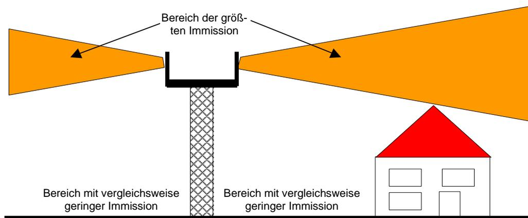
**Abb. 4:** Vertikales Bündelungsverhalten von Mobilfunkantennen (prinzipielle Darstellung).
